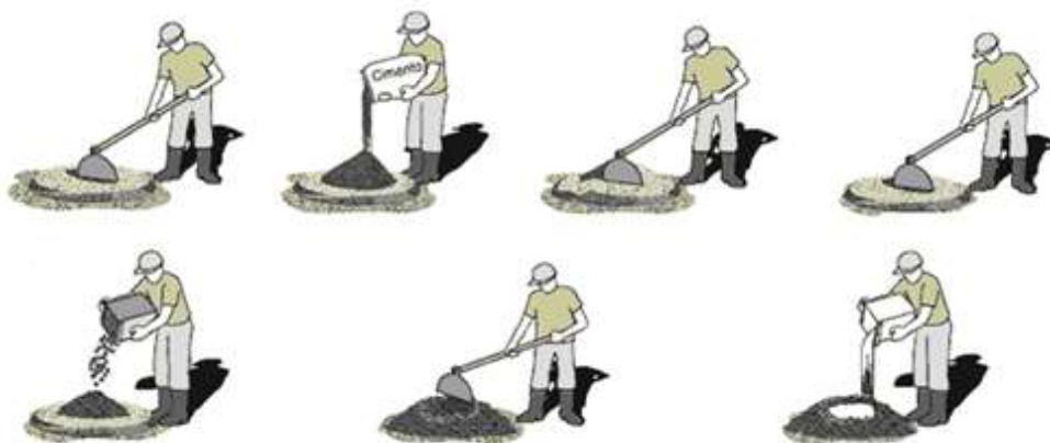
Figura 31 – Mistura manual de concreto.
